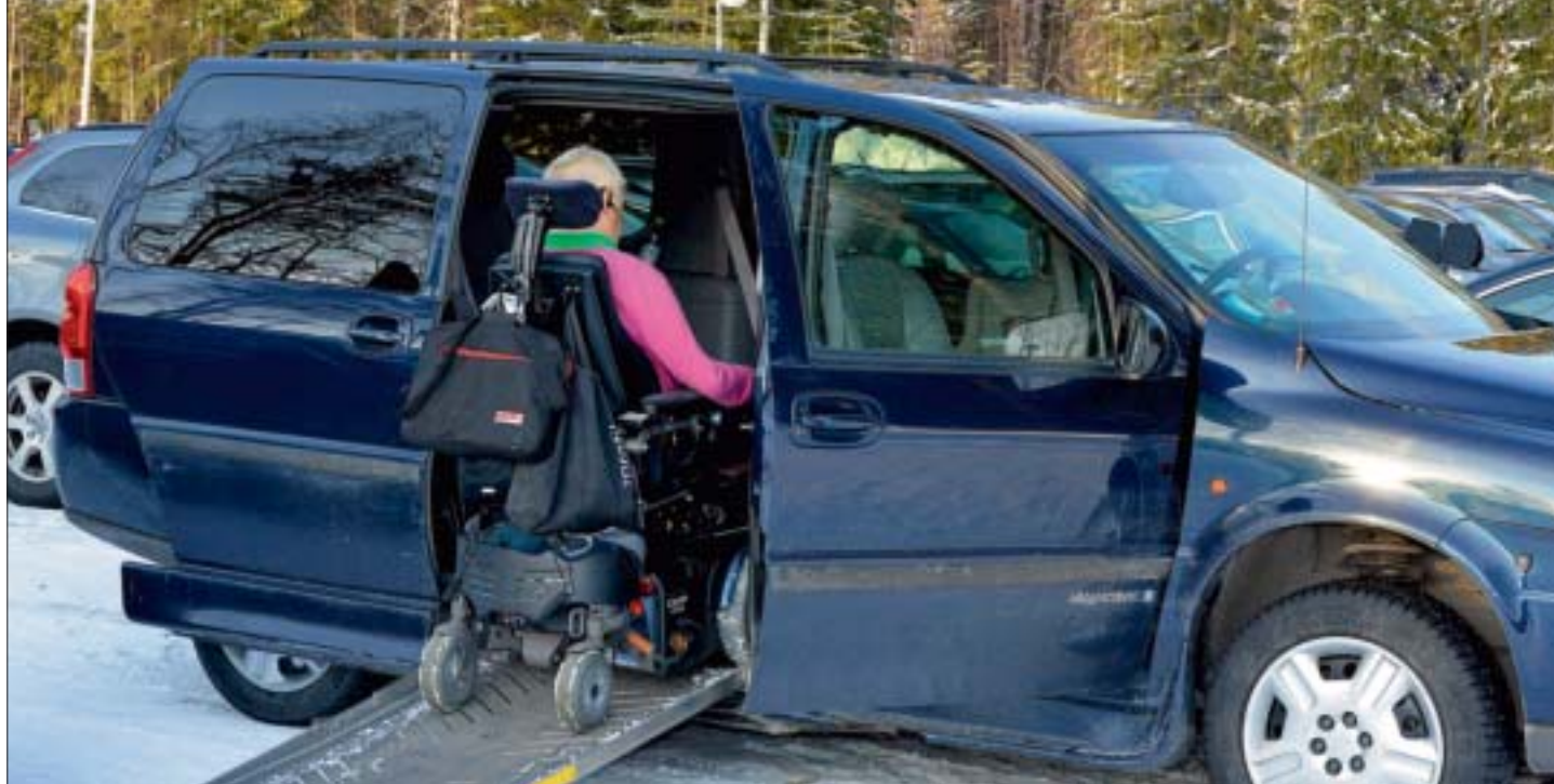
Anpassad körning. Golvsänkning med ingång från sidan är en av många anpassningar som kan utföras med hjälp av bilstöd.
